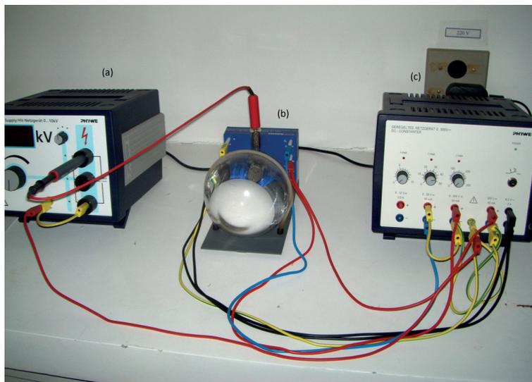
**Figura 1** – Detalhe do experimento didático de difração de elétrons: (a) fonte de tensão; (b) tubo de difração de elétrons com suporte; (c) alimentação regulável de energia para o feixe de elétrons.
